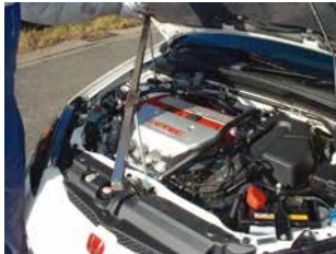
◆車のセンターよりダンパーハウジングの位置を測定している様子。
