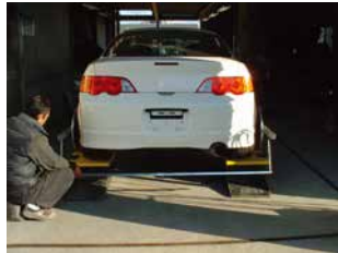
◆測定バーの後端と前端を測定している様子。長方形の状態を確認。
