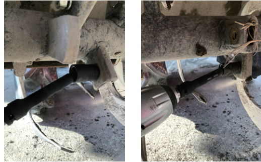
使用例 トラクター爪の交換作業に
