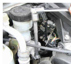
エクステンションとラチェットハンドルを組み合わせている使用例
