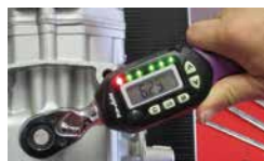
トルク到達度 LEDランプ表示部
